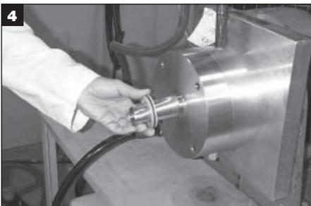
シムストックで形成された筒部の端をシャフトの端と合わせます。
