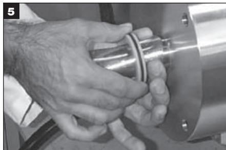
シャフトの端の上部にシムストックで形成された筒部を開けて、一方の端をシャフト上に滑らせます。
