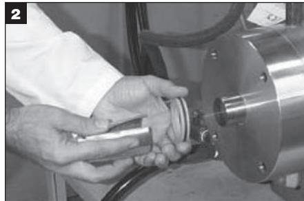
厚さ0.005"の真鍮製シムストックをシャフトの外周より（約1/4インチ程）大きく切って使います。シムストックを回転しシール内に設置します。
